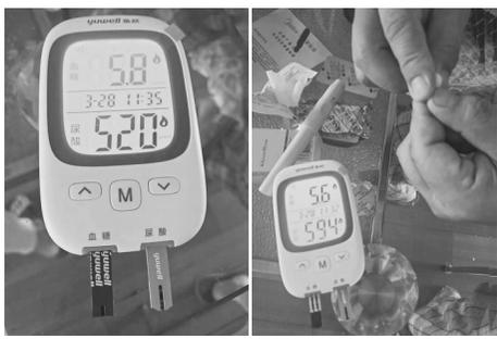
仪器显示,同一时间段、同一手指血样,检测的尿酸值相差很大。
